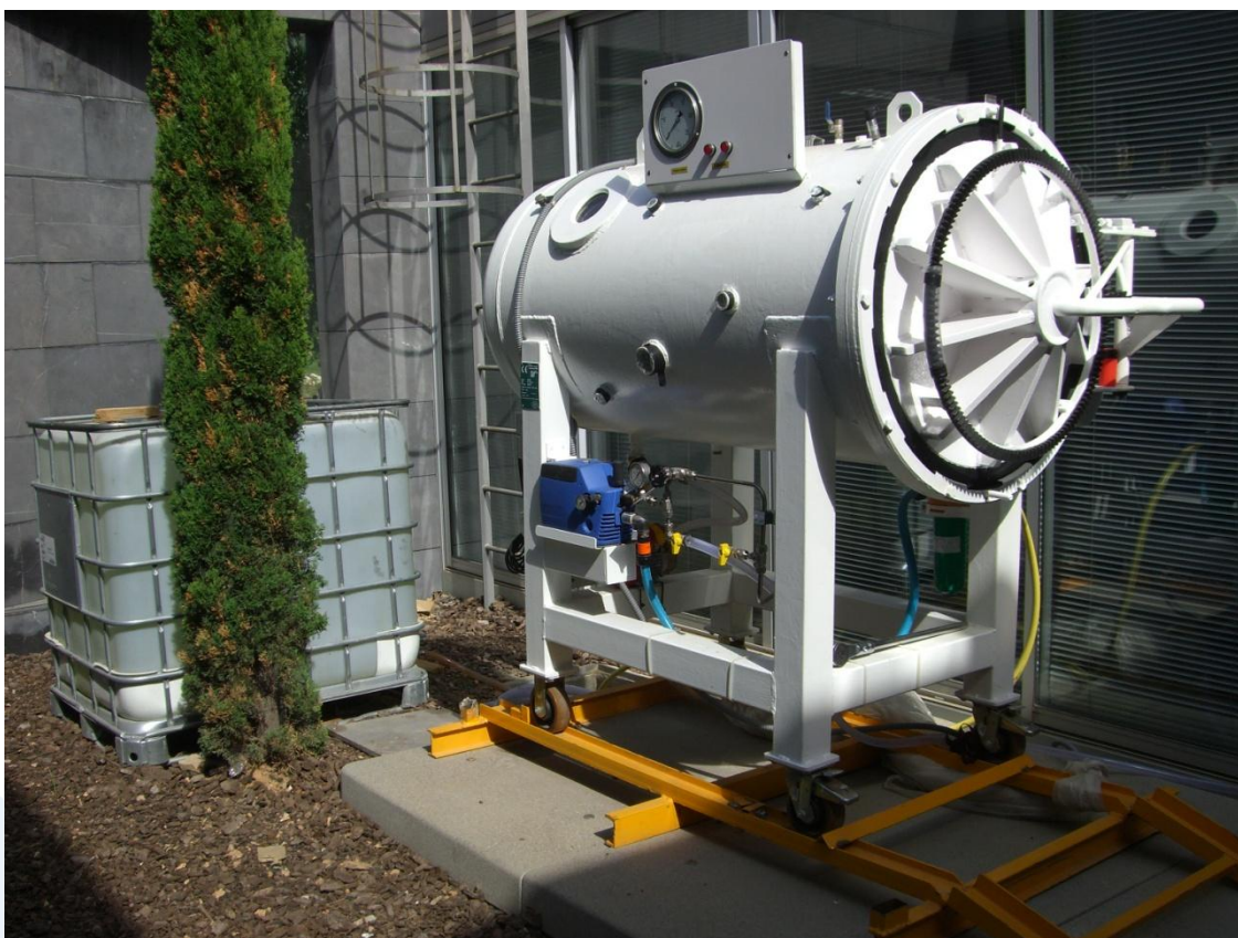
Figura 5. Cambra hiperbàrica. Pressió treball màxima 20 bar
