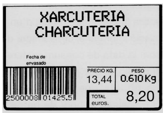
Figura 5. Codi de barres: uns nombres són codificats amb barres negres i blanques llegibles òpticament
