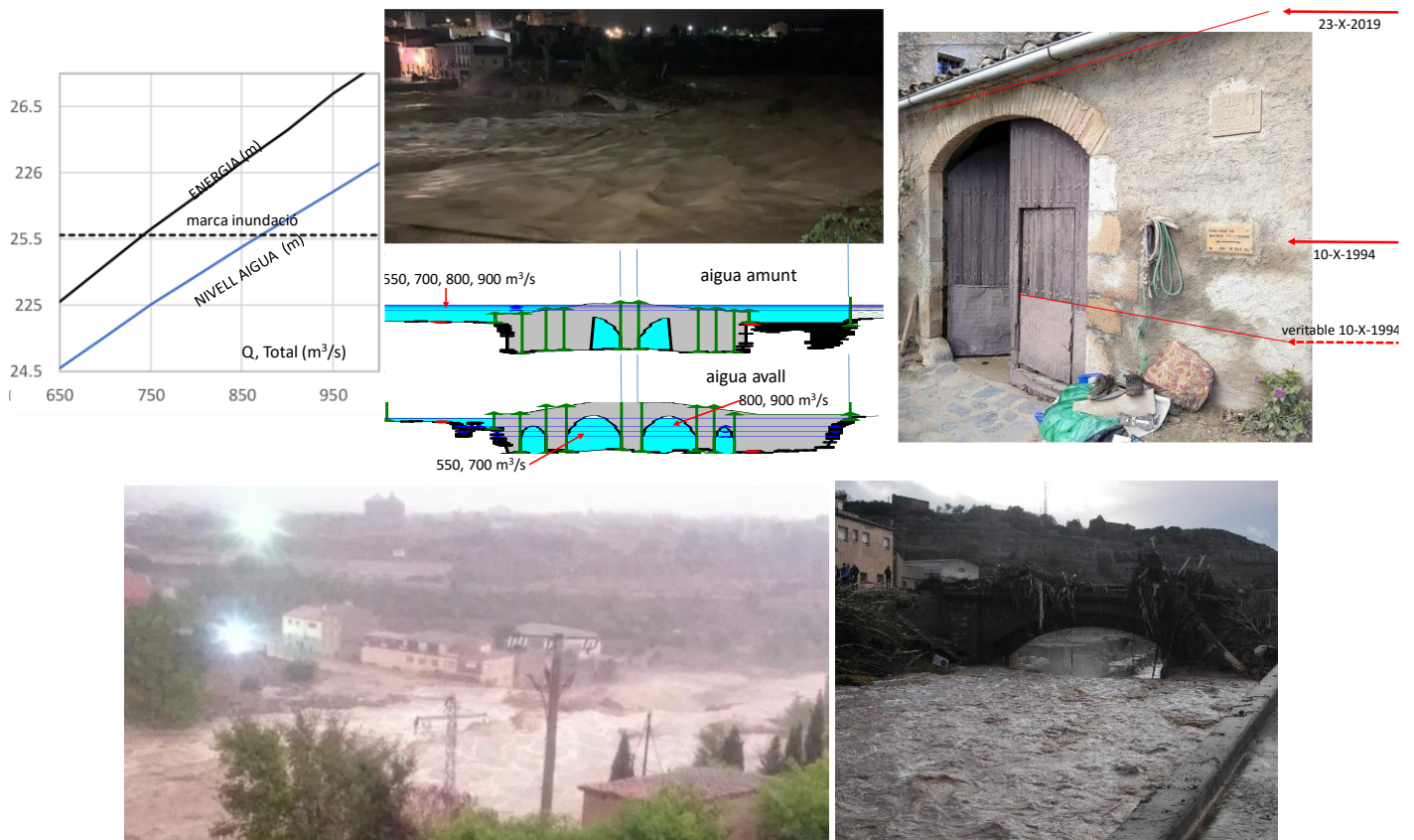
Fig.9. a) diagrama H-Q per a la determinació del cabal al pont de Cal Cisquet de La Riba; b) foto del flux des de marge esquerra i representació a Hec-Ras del tap per flotants de la cara aigua amunt del pont vell de Montblanc; c) molí de Can Guasch, patí a recer del riu, marca de 1994 (la veritable no és la de la placa) i marca molt més alta de 2019; d) imatge d'un vídeo en el moment d'un llampec del centre de L'Espluga, amb el pont a la dreta; e) el pont d'un sol ull, net l'endemà al matí, excepte els troncs a sobre del tauler.
