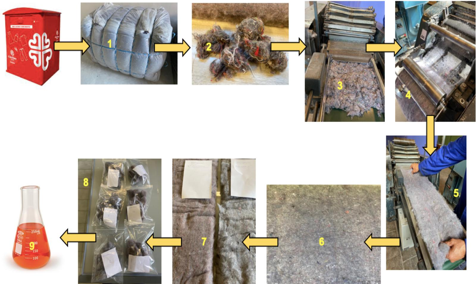
**Proceso de muestreo y homogenización del triturado de la ropa para determinar la composición de fibras (UNE-EN-ISO 1833)**
