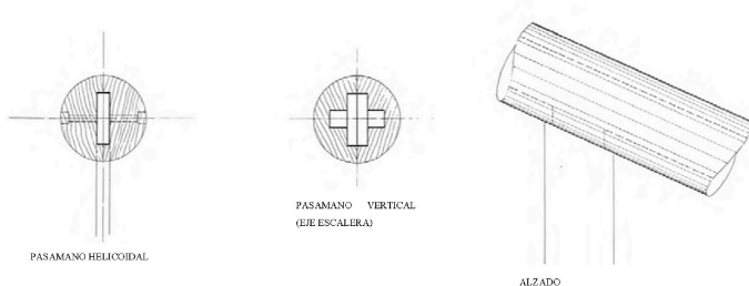
Escalera helicoidal. Detalles de la barandilla de madera continua con estructura interior de pletina de hierro.
