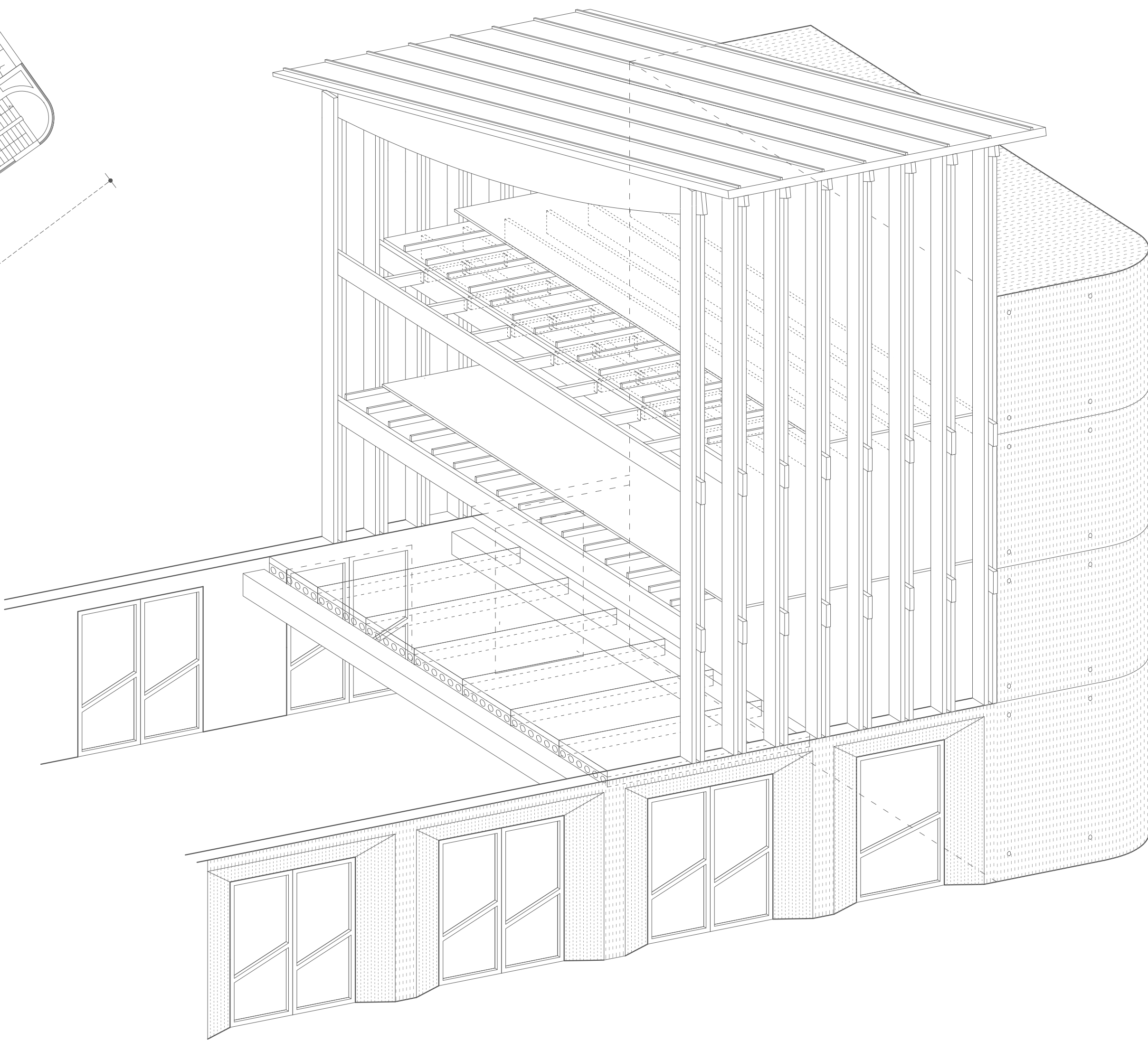
AXONOMETRIA DEL SISTEMA DE CONSTRUCCIÓ
