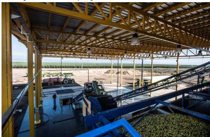
Traslado de la aceituna hacia tolvas donde se incluye limpieza por aire y agua
