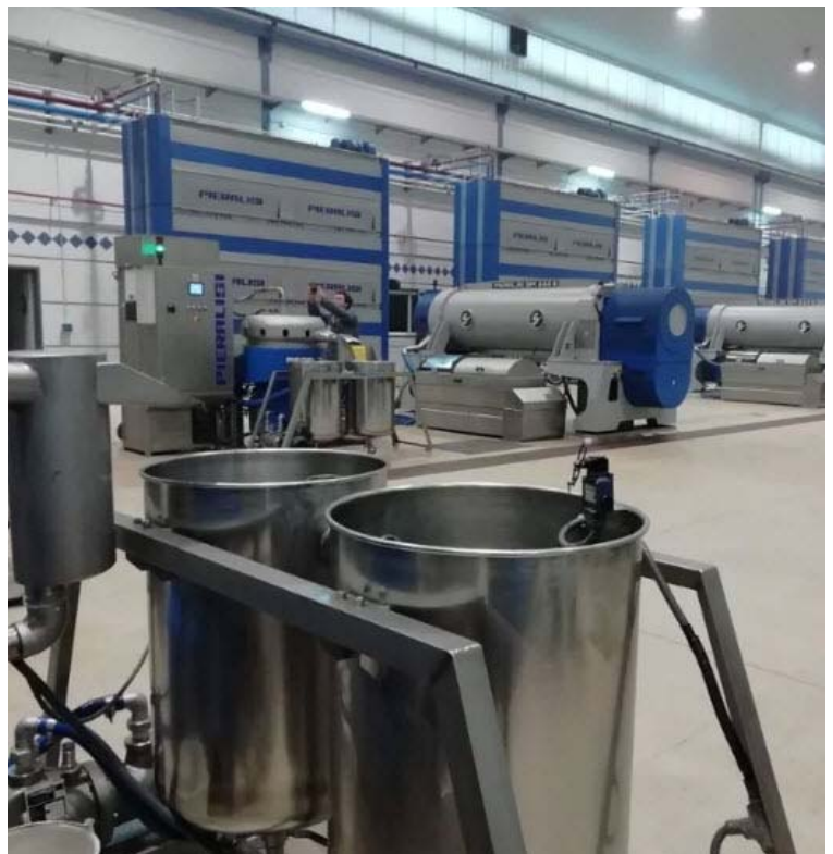
Traslado de la aceituna hacia tolvas donde se incluye limpieza por aire y agua
